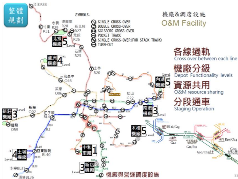
圖 6 臺北捷運路網機廠與營運調度整合規劃
