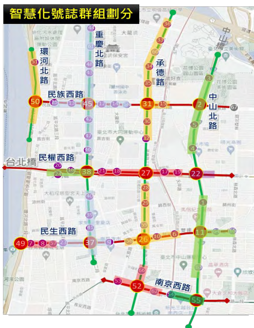
圖 8 動態號誌控制群組劃分示意圖
